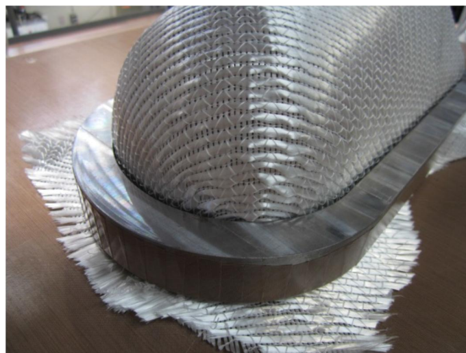
Abbildung 7: Drapierfehler im sphärischen Bereich
