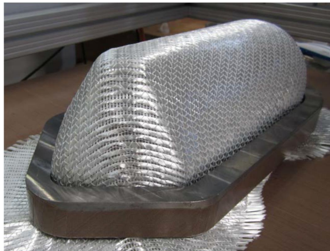
Abbildung 2: Drapierfehler am Tetraeder
